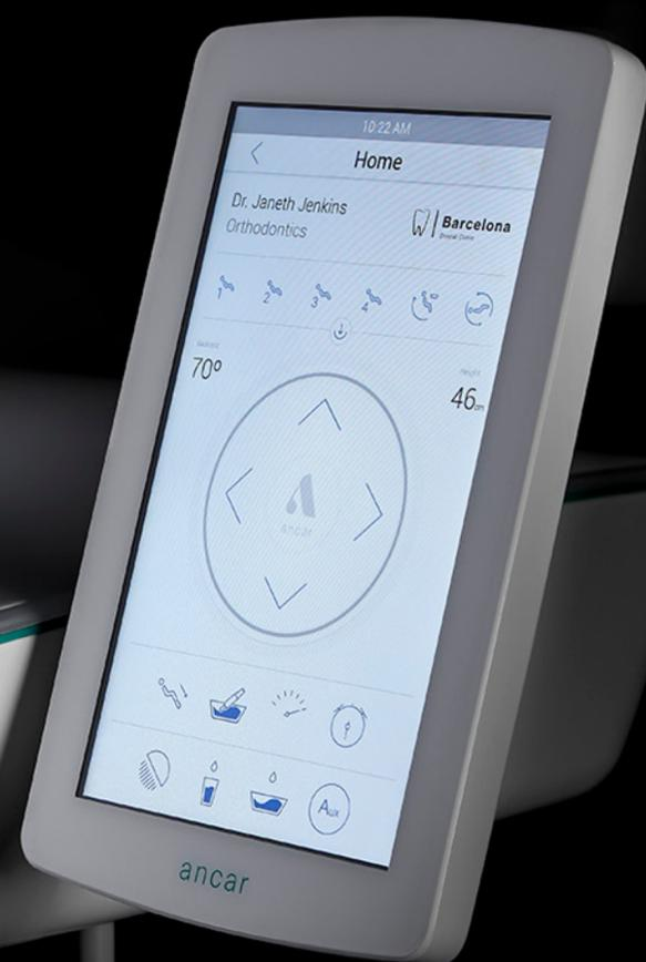
Écran multi-touch couleur de 7 pouces basé sur Android, orientable, avec technologie IPS et facile à utiliser.
